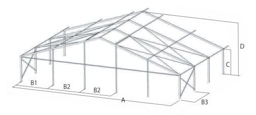
間口(A): 15.07m 柱間(B1): 3.04m (B2): 3.00m (B3): 3.00m 軒高(C): 2.49m 全高(D): 5.23m 屋根傾斜: 20°
